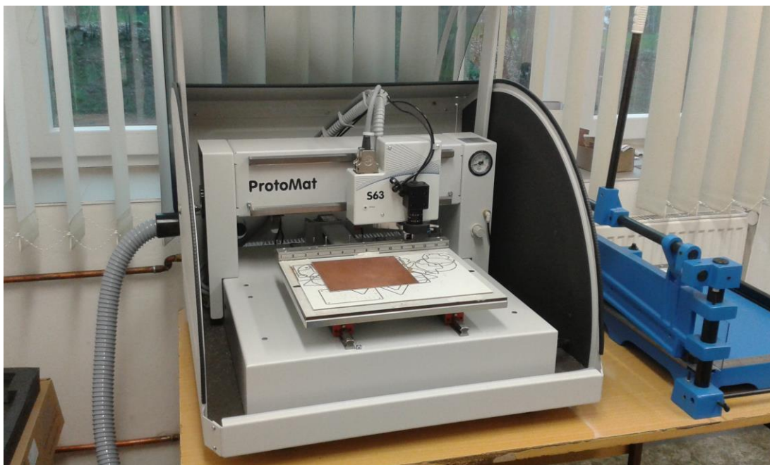
Obr. 11: CNC frézka připravena k začátku frézování.
