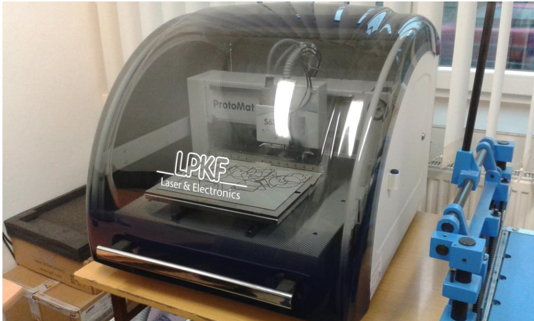
Obr. 10: CNC frézka použitá na vyřezání vodivých cest do DPS.
