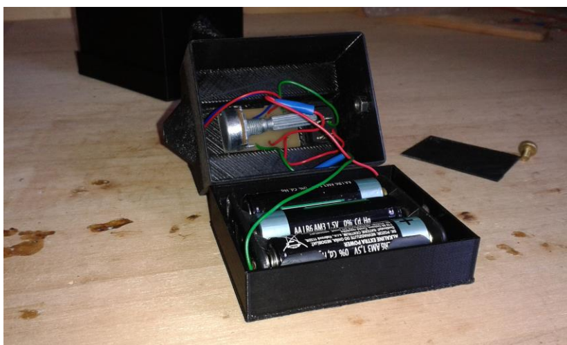
Obr. 27: Dokončený vnitřek laserové části.
