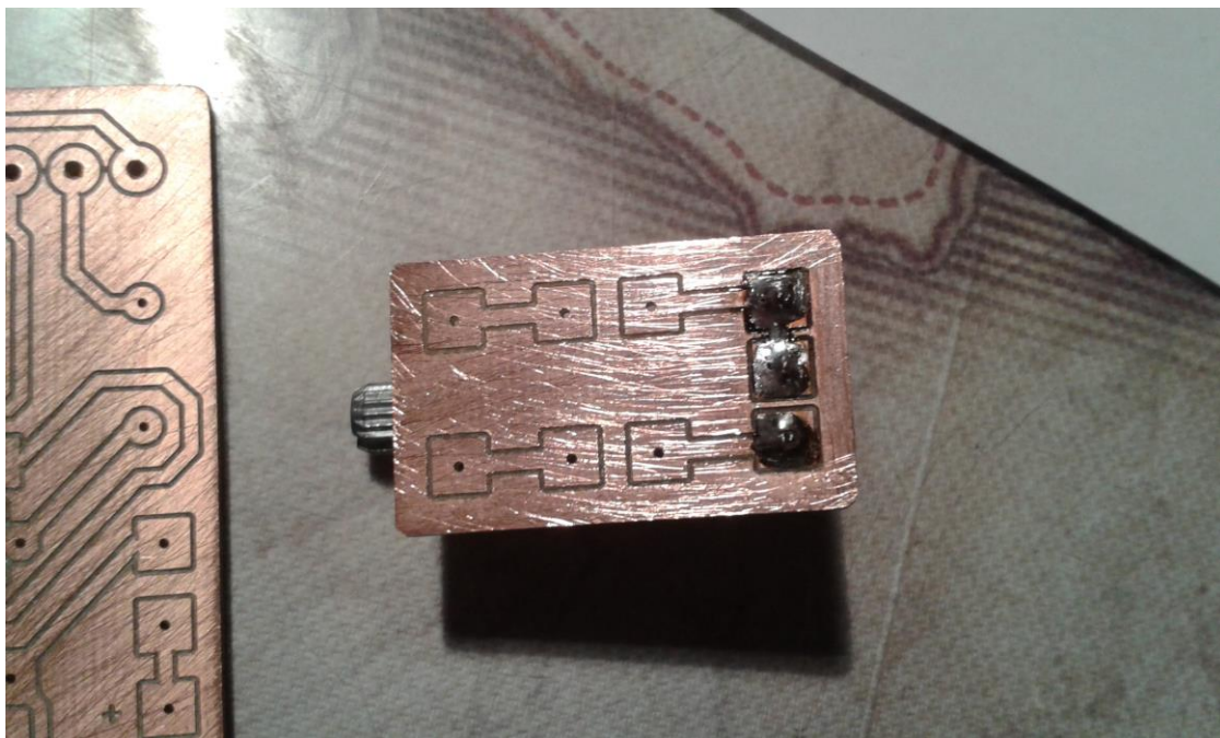
Obr. 12: Vyfrézovaná DPS laseru s připojeným potenciometrem.
